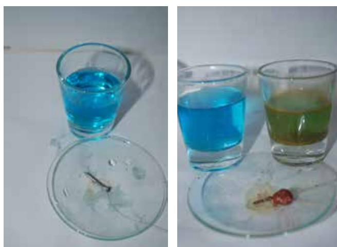
Figura 3. A la izquierda se muestran clavo y disolución, a la derecha lo que queda del clavo 24 horas más tarde y se compara con una disolución idéntica a la inicial. Se observa el cobre depositado y el cambio del color de la disolución.
