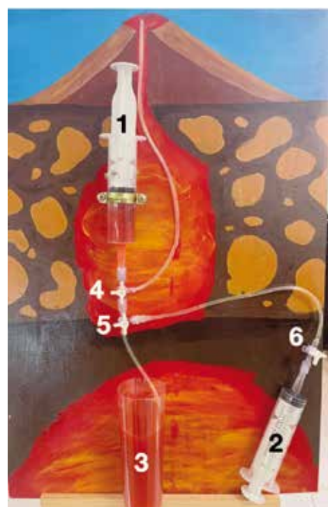
Figura 1. Transposición didáctica de los procesos físicos que ocurren durante una erupción volcánica. La jeringuilla 1 se conecta al contenedor de líquido 3 y a la jeringuilla de presión 2 mediante unos tubos regulados por las llaves de paso 4, 5 y 6.
