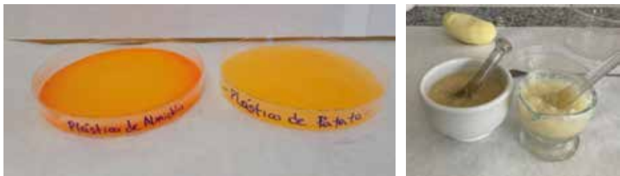
Figura 3. Almidón de patata y películas de biopolímero: a la izquierda, película basada en almidón comercial y, a la derecha, película basada en almidón de patata [20].
