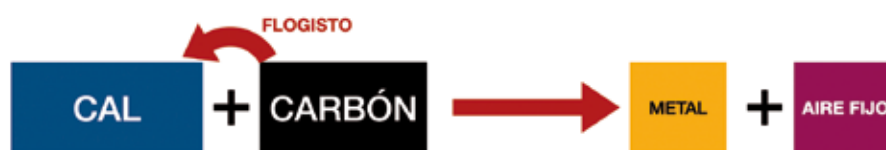
Figura 2. Tratamiento de cales con carbón según la teoría del flogisto.
